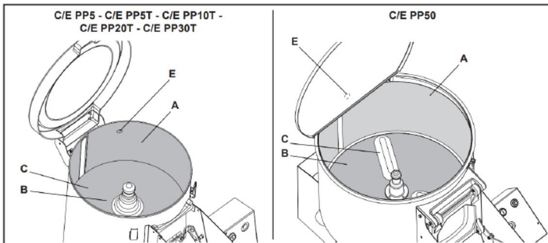
BEIM BEFÜLLEN DES BEHÄLTERS MIT DEM ZU SCHABENDEN PRODUKT EMPFEHLEN WIR EINE MAXIMALE FÜLLHÖHE VON CA. 7 CM AB BEHÄLTERRAND. NUR DANN HAT DAS PRODUKT WÄHREND DER VERARBEITUNGSPHASE GENÜGENDE BEWEGUNGSFREIHEIT.
